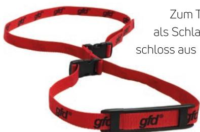
Zum Tragen von 2-4 Rollschläuchen üblicher Größe, auch als Schlauchhalter zu verwenden. Aus Polypropylen, Steckschluss aus Nylon, Tragegriff. Tragkraft 90 kg, Länge 1850 mm, Gurtbreite 25 mm, ca. 70 g.
